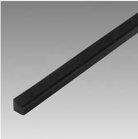
Kederprofil (Art.-Nr. 980.8.0099.00) Kederprofil aus Silicone zum Abdichten des Zwischenraums zwischen Frontplatte und Gehäuse. Einfach zuzuschneiden und vor Frontplattenmontage einzusetzen.
